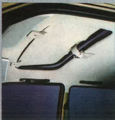
De 1,3S heeft een stalen open dak, dat gemakkelijk uitgenomen kan worden.
