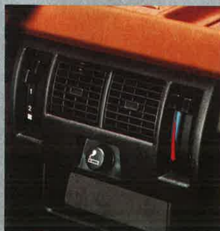
Bediening van verwarming en ventilatie.
