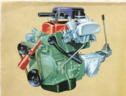
Moteur de 1622 cm 3 - taux de compression 8,3 à 1 - vilebrequin équilibré - pistons en alliage d'aluminium - deux carburateurs S.U.
