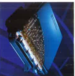
De geavanceerde microprocessor van de 105 pk L-serie turbodieselmotor maakt gebruik van de informatie van tal van sensoren om prestaties, verbruik en emissies doorlopend bij te stellen.
