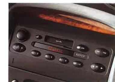
De standaard Philips radio-cassettespeler is uitgerust met RDS, heeft een uitgangsvermogen van 4 x 7 W, en wordt gecombineerd met 6 luidsprekers.
