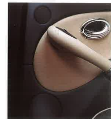
Het 'Audio Pack' en het 'Studio Pack' maken beide gebruik van separate 'tweeters' in de achterportieren.
